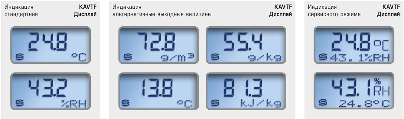
По умолчанию на дисплее попеременно отображаются **измеренная температура** и **измеренная влажность** (относительная влажность).
