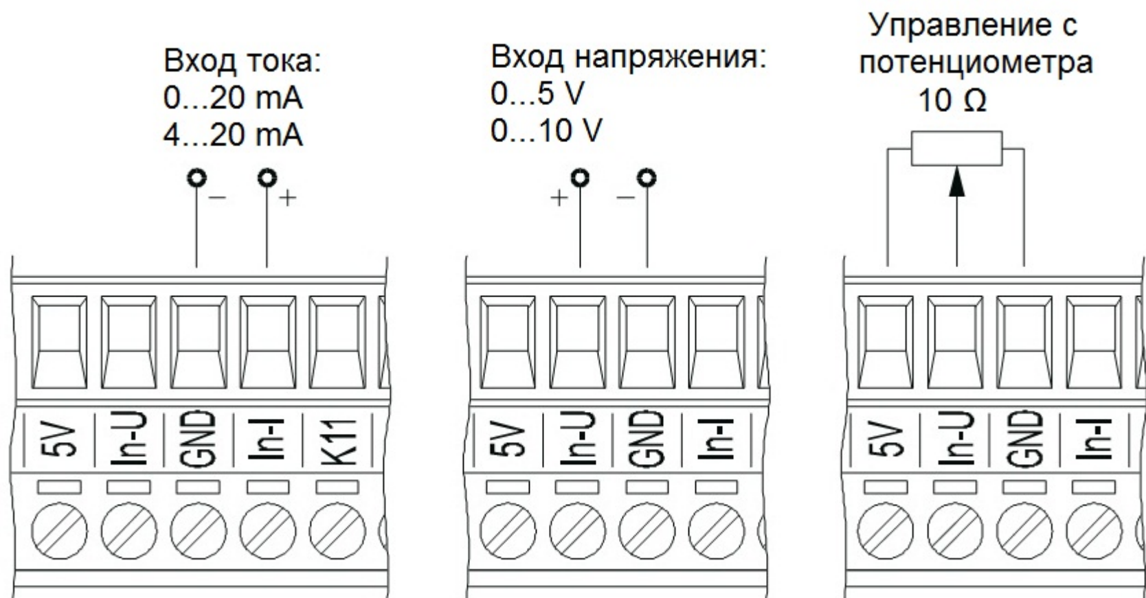
Рис.5. Подключение управляющих сигналов
