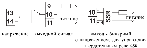
Рис 3. Подключение питания и выходного сигнала.
