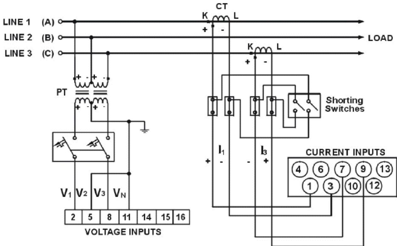
Рисунок 9 Трехпроводное соединение открытым треугольником, использующее 2 трансформатора напряжения, 2 трансформатора тока.
