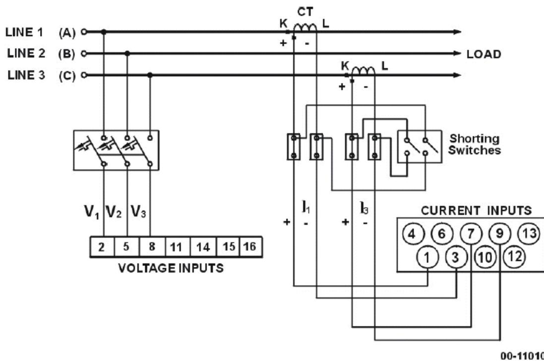
Рисунок 6 Прямое трехпроводное подключение с использованием 2 трансформаторов тока
