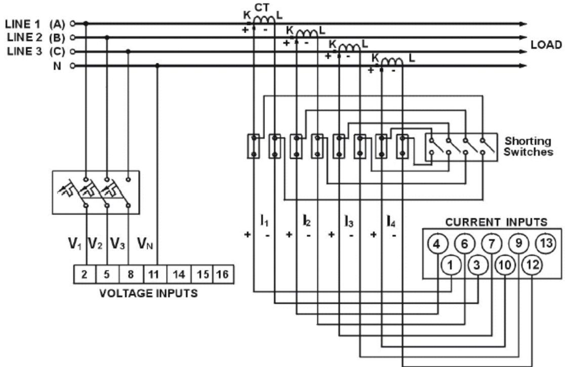
Рисунок 7 Четырехпроводное соединение, использующее 4 трансформатора тока, 3 фазных и 1 нейтраль.
