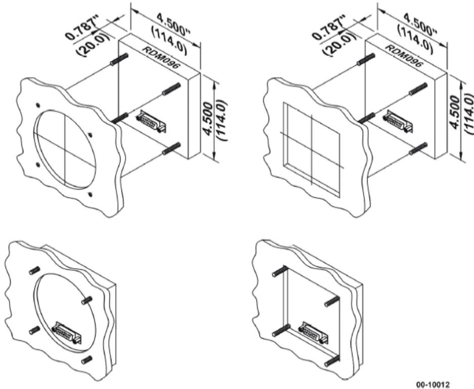
Рисунок 5 Механическая установка и размеры внешнего дисплея
