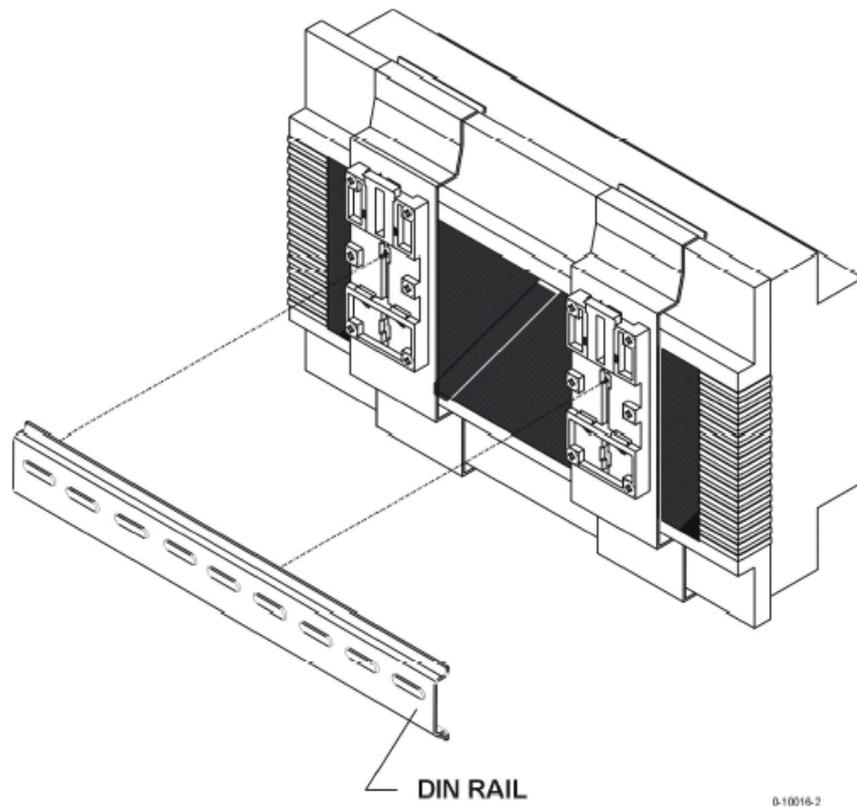
Рисунок 3 Монтаж на рейку DIN
