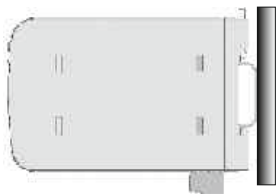
Rys. 3 Montaż na szynie TS-35 (DIN)
