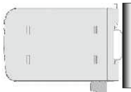
Rys. 3 Montaż na szynie TS-35 (DIN)
