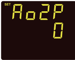
Fig 3-22 AO2 Parameter Setting
