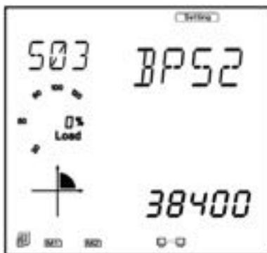
Рисунок 5-53 Настройка скорости передачи для модуля АХМ-RS485
