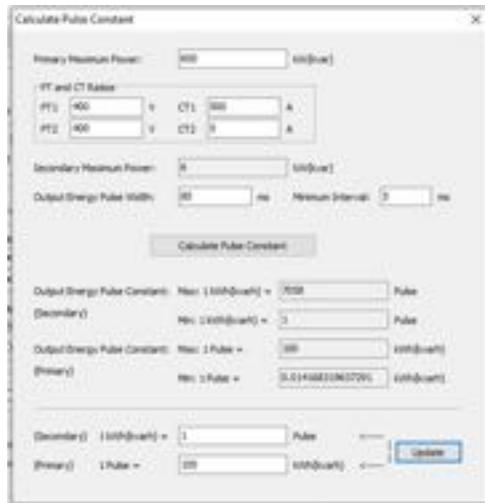
Рисунок 5-36. Калькулятор постоянной импульса из программного обеспечения Asview.
