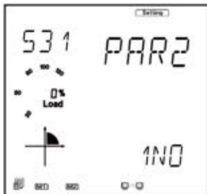
Рисунок 5-54. Настройка четности для модуля AXM-RS485
