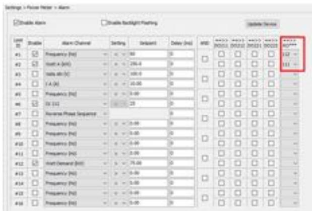
Рис. 5-31. Конфигурация срабатывания тревожного реле из программного обеспечения Acuvim.
