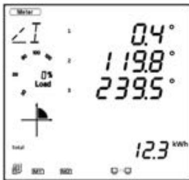
Рис. 3-11 Страница текущего фазового угла
