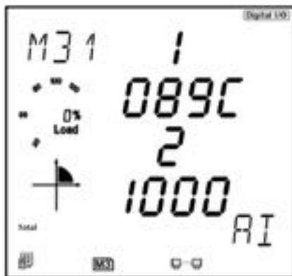
Рис. 5-42 Показания аналогового входа с дисплея счетчика
