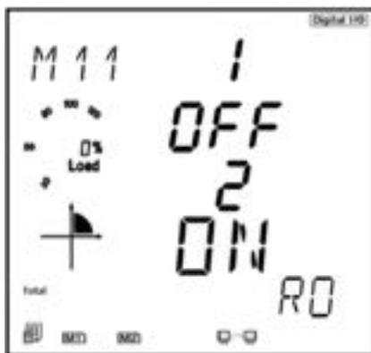
Рисунок 5-29 Показания статуса (состояния) релейного выхода
