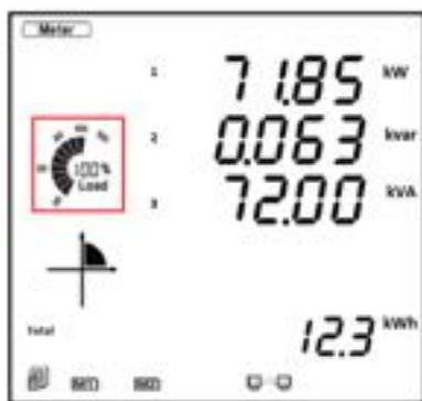
Рис. 4-20 - Процент нагрузки
