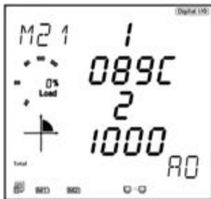
Рисунок 5-37. Показания аналогового выхода с дисплея прибора
