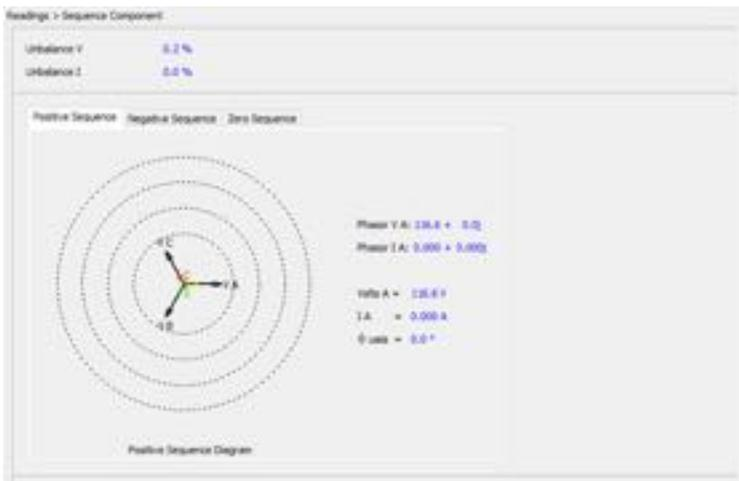
Рисунок 4-16 - Показания небаланса и последовательности
