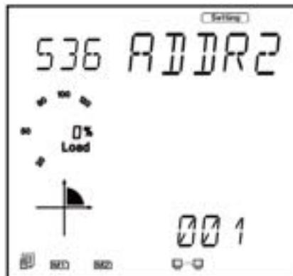
Рисунок 5-55. Настройка адреса для AXM-RS485
