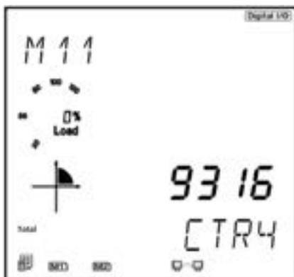
Рисунок 5-22. Счетчик импульсов на цифровом входе с дисплея прибора.
