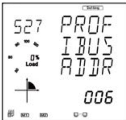
Рис. 5-50. Установка адреса AXM-PROFI на дисплее прибора
