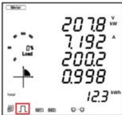
Рисунок 5-34 Индикатор импульсного сигнала на дисплее прибора
