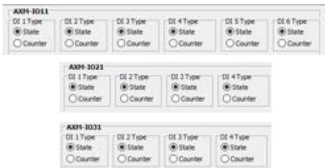
Рисунок 5-18 Конфигурация статуса цифрового входа
