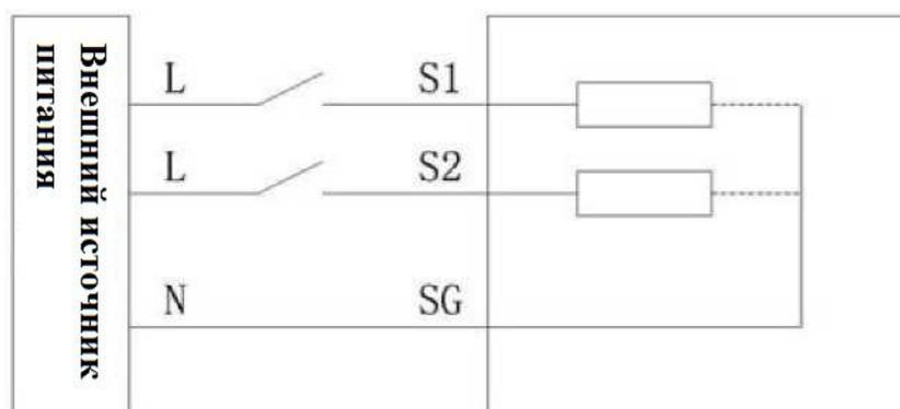
Обычно внешний модуль и соответствующий ЖК-дисплей отображения состояния DFPM33 не активны, информация о внутреннем состоянии установлена на 1; внешний модуль отключен, соответствующий ЖК-дисплей отображения состояния DFPM33 отключен, информация о внутреннем состоянии установлена на 0.
