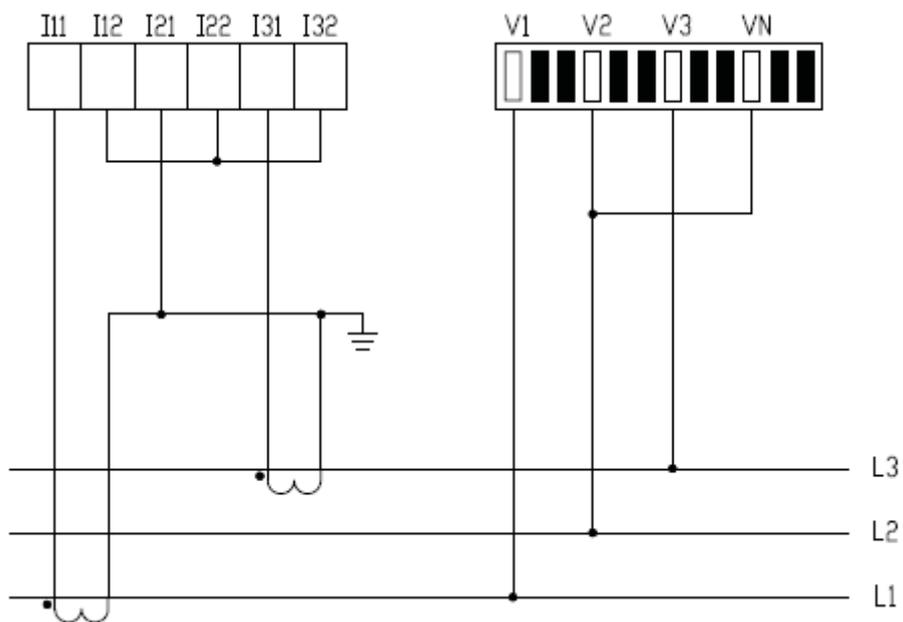
Схема подключения, электрические параметры в трехфазном четырехпроводном режиме подключения с цифровыми входами состояния и одним портом RS485:
