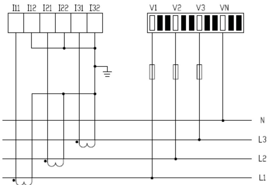
Трехфазная трехпроводная система, 3 ТТ:
