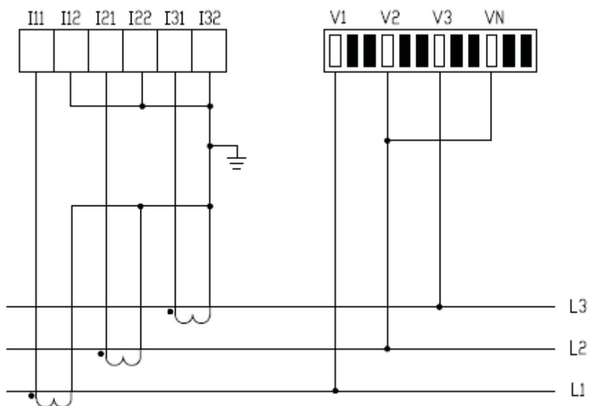
Трехфазная трехпроводная система, 2 ТТ:
